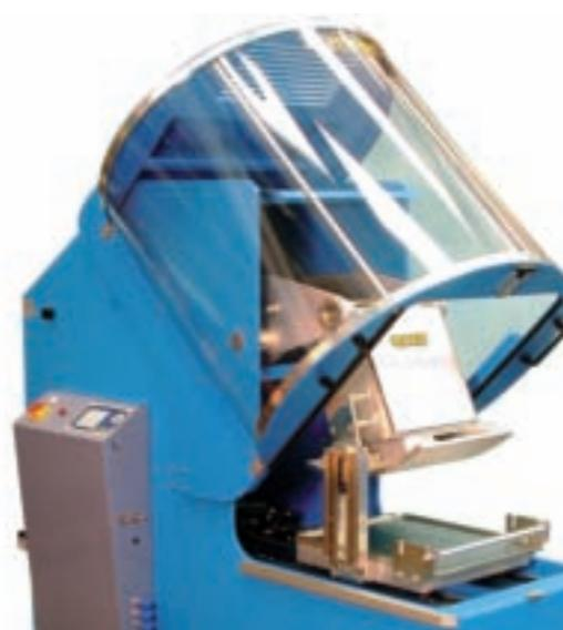
**B038 Wheel tracker:** установка разработана для оценки устойчивости к колеообразованию образцов асфальтобетона в условиях, максимально имитирующих эффект тихоходного трафика.
