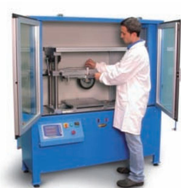
**A128N Абразивный износ:** Установка используется для определения сопротивления истиранию шинами автомобилей заполнителей верхнего слоя дорожного покрытия.
