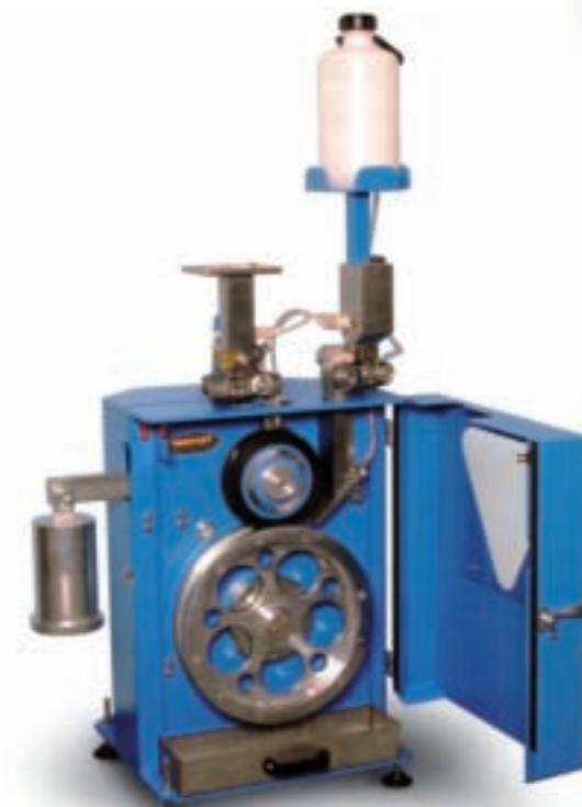
**B070N Автоматический аппарат "Кольцо и шар"** для автоматического определения температуры размягчения битумов и смол.
