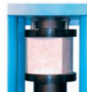
Сжатие бетонных образцов
