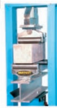
изгиб образцов бетона
